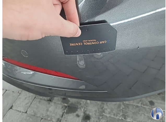
1. Achterbumper Krassen - Spot Repair/Deelreparatie
