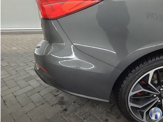
1. Achterbumper Krassen - Spot Repair/Deelreparatie
