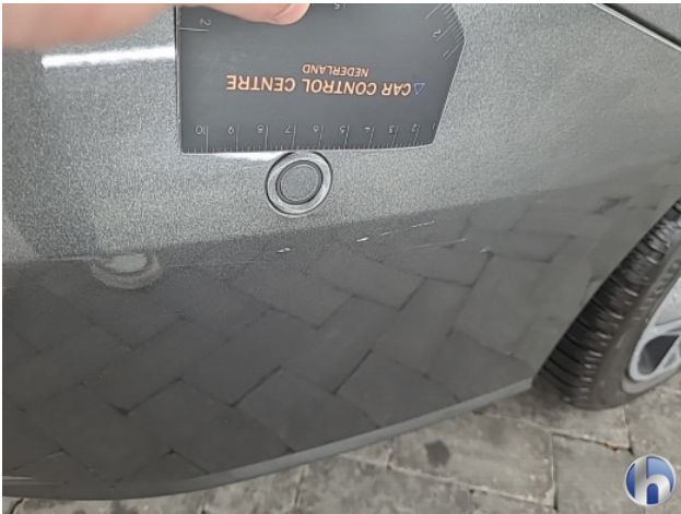
1. Achterbumper Krassen - Spot Repair/Deelreparatie
