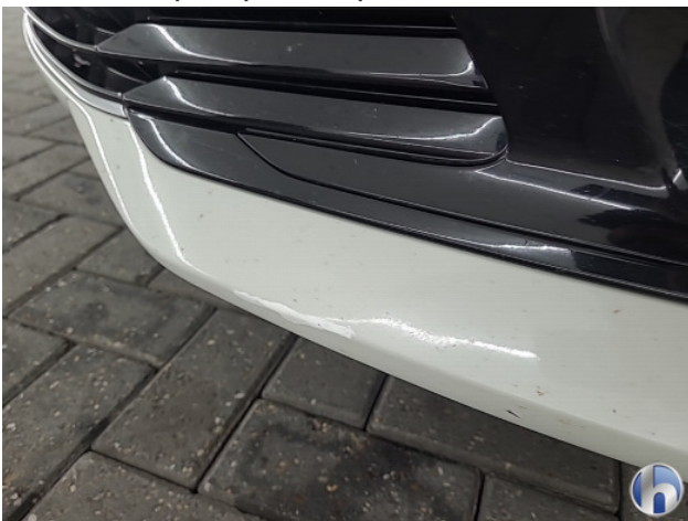
1. Voorspoiler Deuk/deuken - Spot Repair/Deelreparatie
