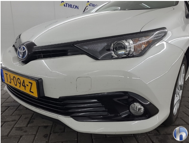
1. Voorspoiler Deuk/deuken - Spot Repair/Deelreparatie
