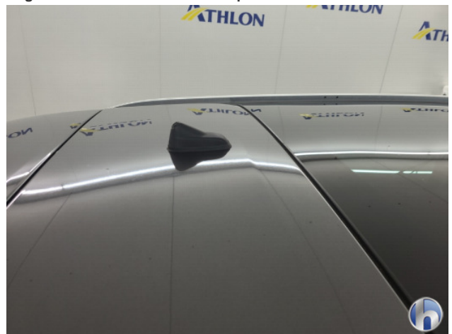
2. Dak Hagelschade - Herstellen zonder spuiten
