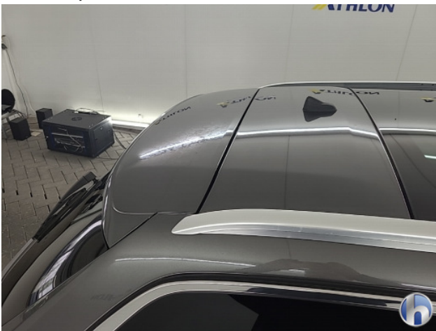
2. Dak Hagelschade - Herstellen zonder spuiten
