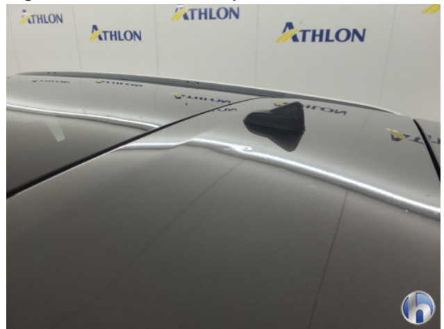
2. Dak Hagelschade - Herstellen zonder spuiten
