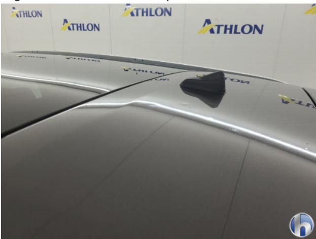
2. Dak Hagelschade - Herstellen zonder spuiten
