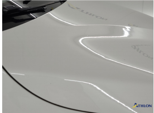
1. hagelschade dak Deuk/deuken
