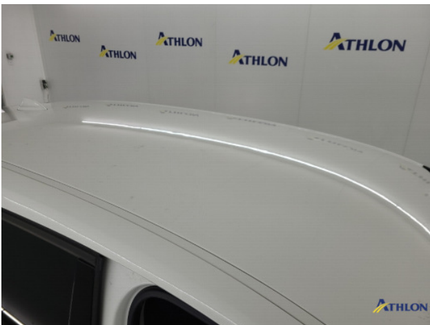
1. hagelschade dak Deuk/deuken
