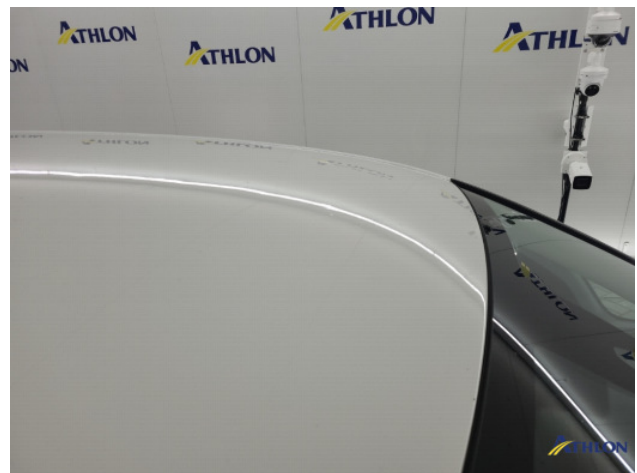
1. hagelschade dak Deuk/deuken
