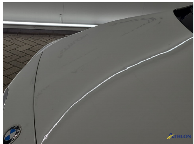
1. hagelschade dak Deuk/deuken
