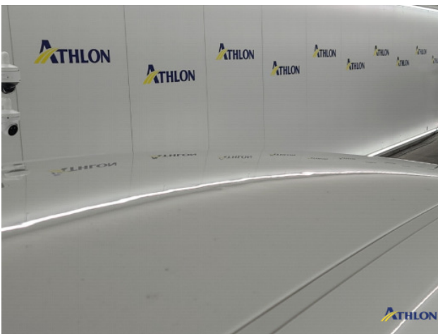
1. hagelschade dak Deuk/deuken
