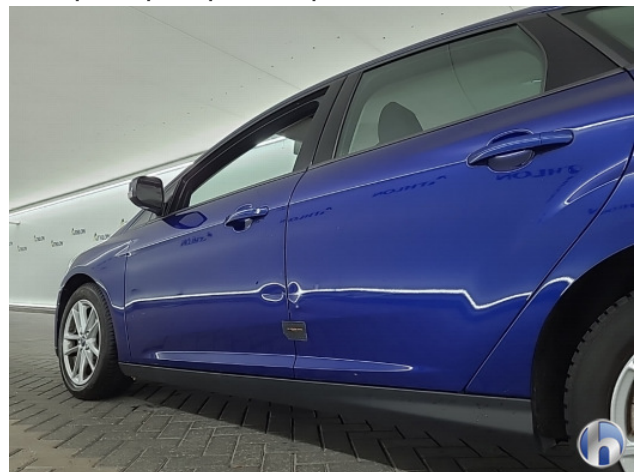
2. Portier achter - links Deuk/deuken - Herstellen
