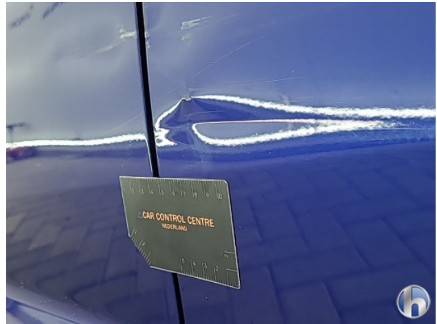
2. Portier achter - links Deuk/deuken - Herstellen
