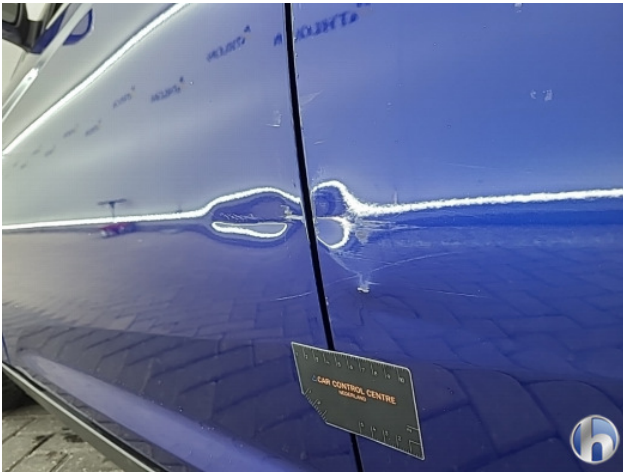
2. Portier achter - links Deuk/deuken - Herstellen
