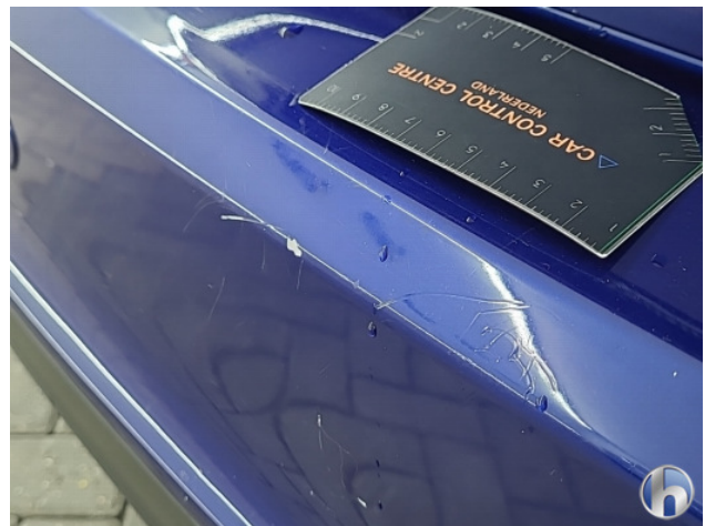
3. Achterbumper Krasen - Spot Repair/Deelreparatie
