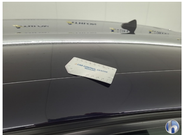
2. Dak Deuk/deuken - Herstellen
