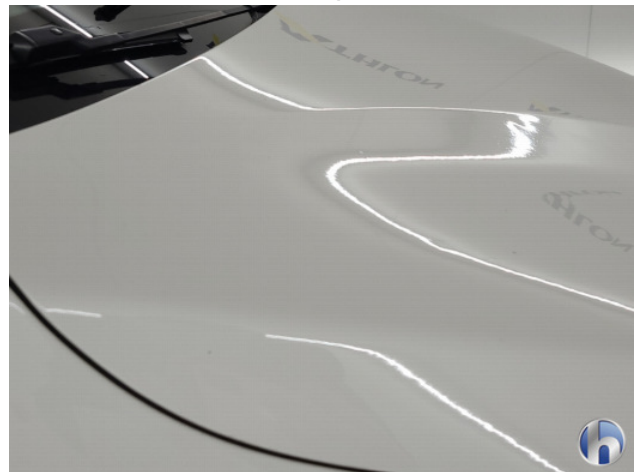
1. hagelschade dak Deuk/deuken - Herstellen zonder spuiten
