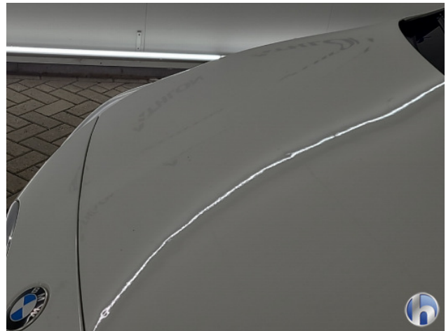
1. hagelschade dak Deuk/deuken - Herstellen zonder spuiten
