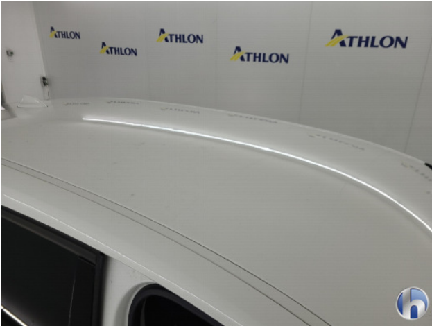
1. hagelschade dak Deuk/deuken - Herstellen zonder spuiten
