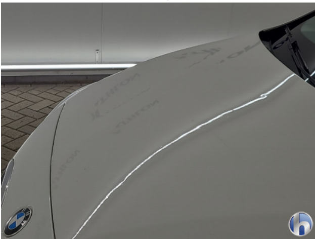
1. hagelschade dak Deuk/deuken - Herstellen zonder spuiten
