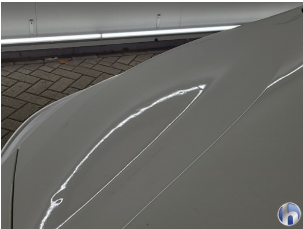
1. hagelschade dak Deuk/deuken - Herstellen zonder spuiten
