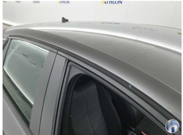
1. B - stijlbekleding Gebruikssporen - Aanvaardbaar
