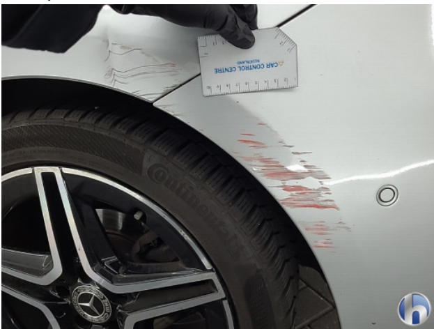
1. Zijwand - achter - Links Schaafplek - Herstellen
