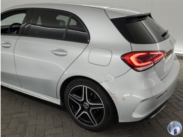
1. Zijwand - achter - Links Schaafplek - Herstellen
