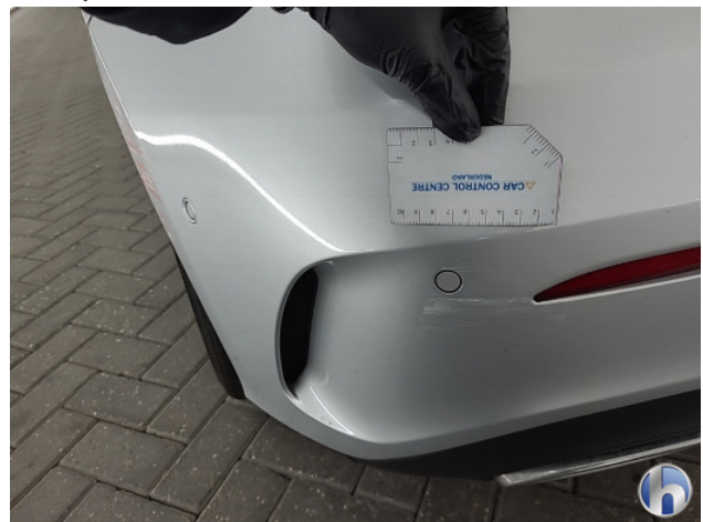
1. Zijwand - achter - Links Schaafplek - Herstellen
