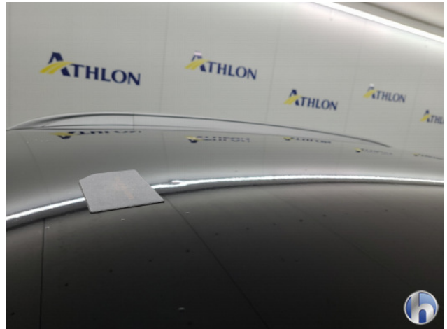
1. Dak Gebruikssporen - Aanvaardbaar
