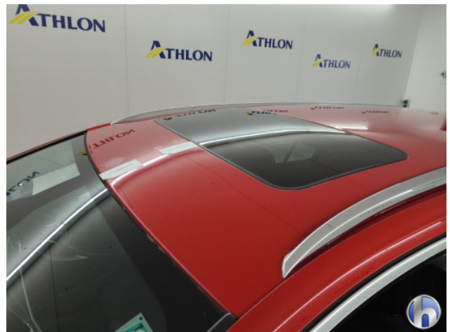
3. ingevreten vogelpoep Beschadigd - Spuiten
