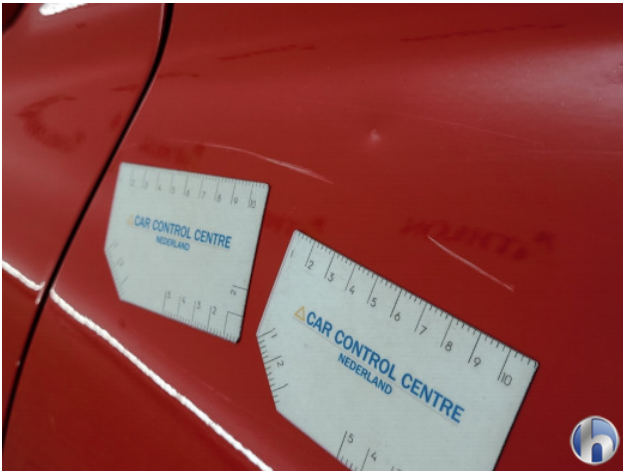
1. Zijwand - achter - Links Deuk/deuken - Spuiten
