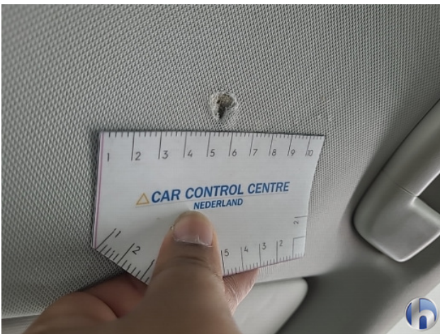
3. diverse interieurdelen Beschadigd - Vernieuwen
