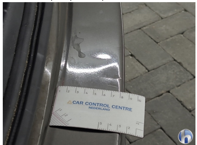
2. Achterbumper Deuk/deuken - Spot Repair/Deelreparatie
