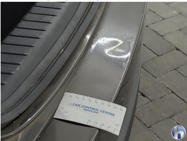
2. Achterbumper Deuk/deuken - Spot Repair/Deelreparatie
