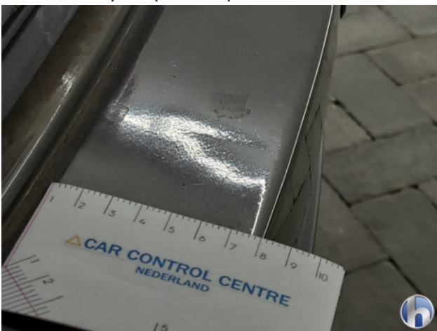
2. Achterbumper Deuk/deuken - Spot Repair/Deelreparatie
