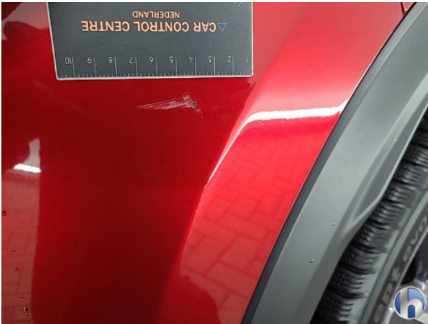
1. Achterbumper Gebruikssporen - Aanvaardbaar
