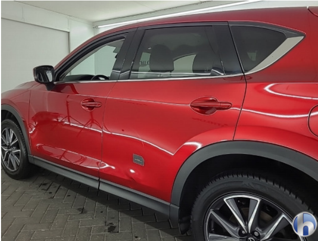
2. Portier achter - links Deuk/deuken - Herstellen
