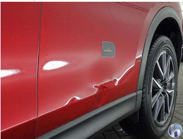
2. Portier achter - links Deuk/deuken - Herstellen
