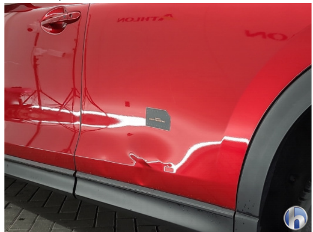
2. Portier achter - links Deuk/deuken - Herstellen
