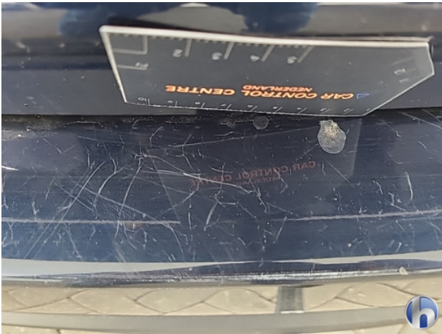
2. Achterbumper Krassen - Spot Repair/Deelreparatie
