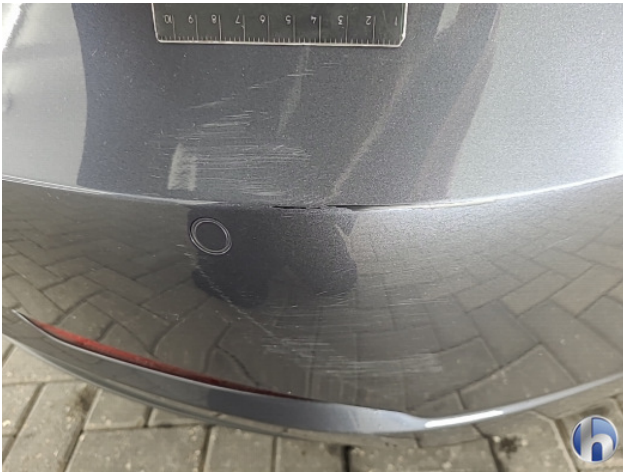
1. Achterbumper Gebruikssporen - Aanvaardbaar
