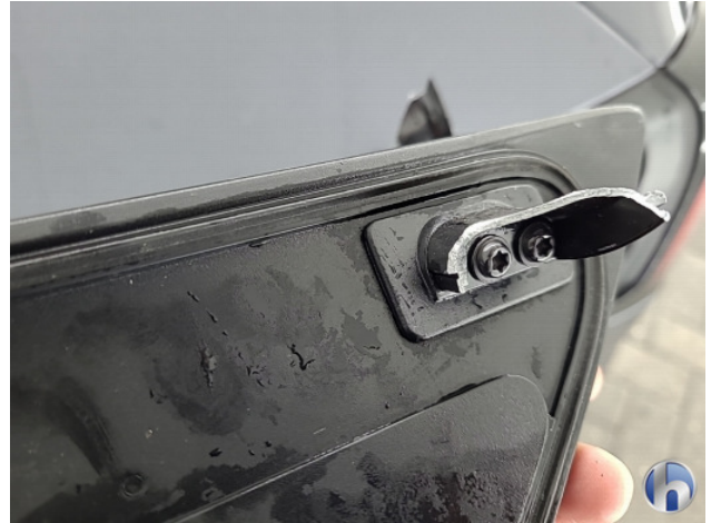
2. Laadpoort kapje Gebruikssporen - Aanvaardbaar
