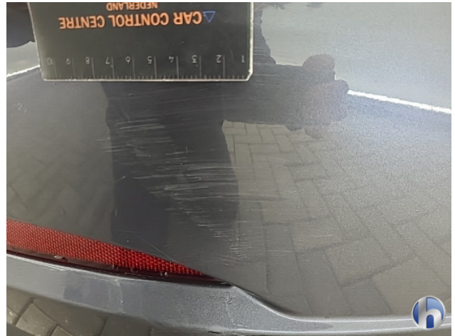
1. Achterbumper Gebruikssporen - Aanvaardbaar
