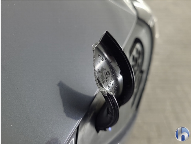
2. Laadpoort kapje Gebruikssporen - Aanvaardbaar
