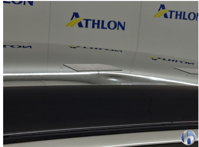
1. Dak Deuk/deuken - Herstellen
