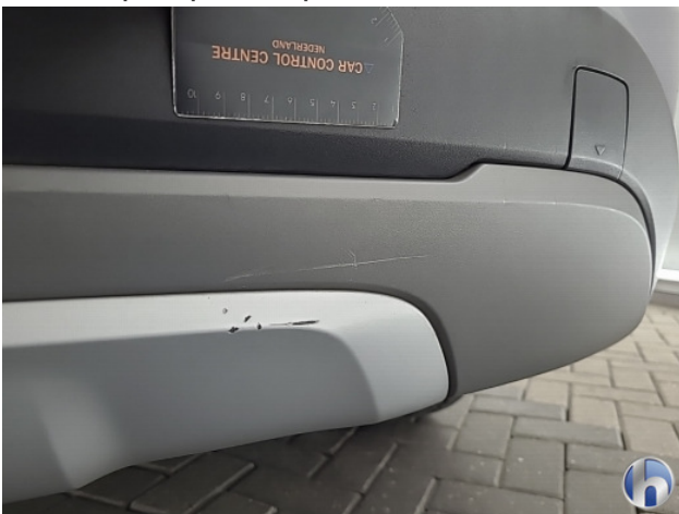
2. Achterbumper Deuk/deuken - Spot Repair/Deelreparatie
