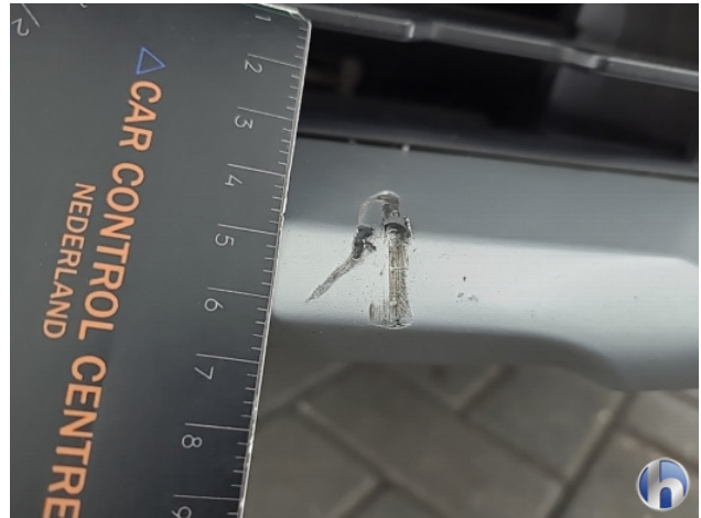
1. Voorspoiler Krassen - Spot Repair/Deelreparatie
