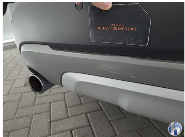
2. Achterbumper Deuk/deuken - Spot Repair/Deelreparatie
