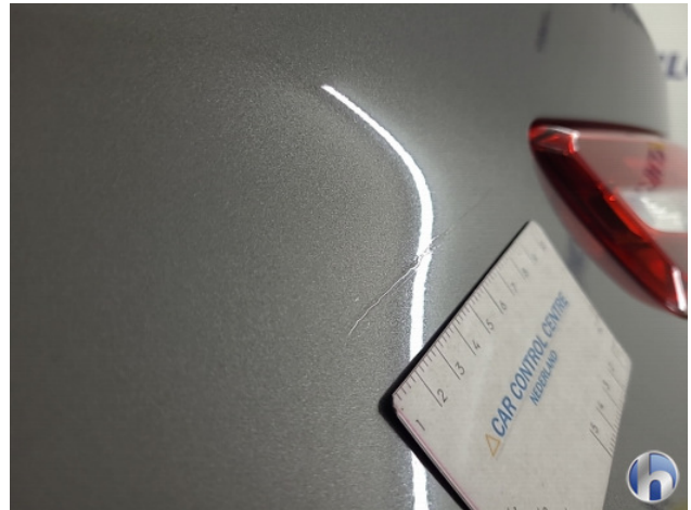
1. Achterklep Gebruikssporen - Aanvaardbaar
