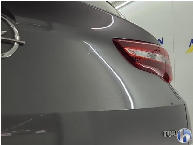
1. Achterklep Gebruikssporen - Aanvaardbaar
