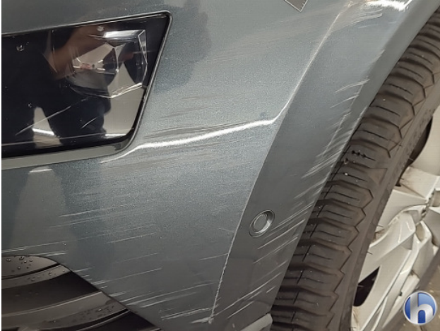
1. Voorbumper Schaafplek - Spot Repair/Deelreparatie
