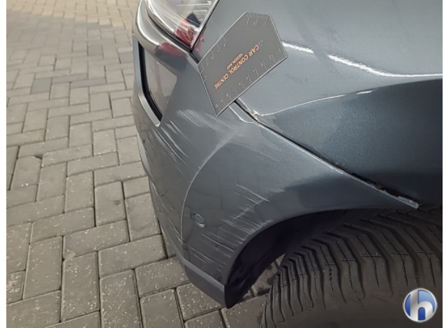
1. Voorbumper Schaafplek - Spot Repair/Deelreparatie
