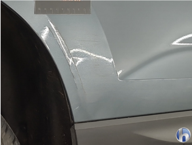
2. Portier achter - rechts Gebruikssporen - Aanvaardbaar
