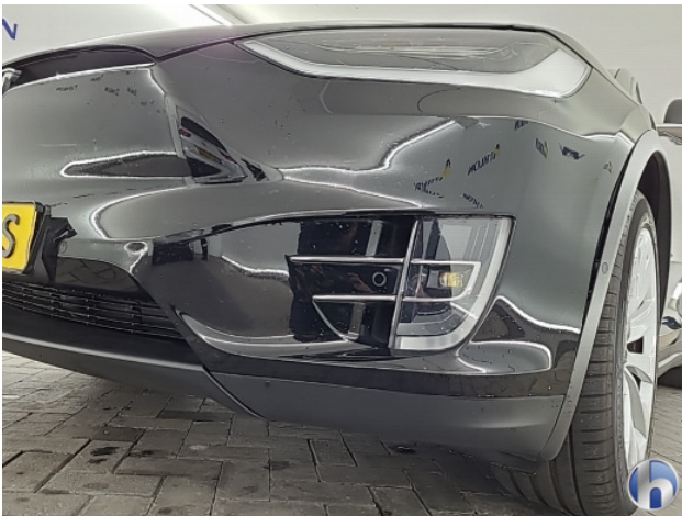
2. Voorbumper Deuk/deuken - Spot Repair/Deelreparatie
