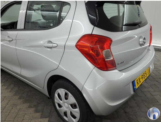
2. Achterbumper Schaafplek - Spot Repair/Deelreparatie
