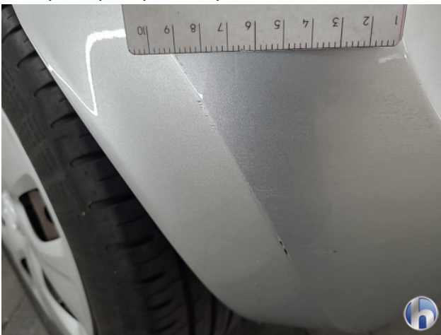
2. Achterbumper Schaafplek - Spot Repair/Deelreparatie
