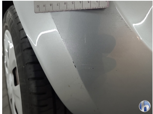
2. Achterbumper Schaafplek - Spot Repair/Deelreparatie
