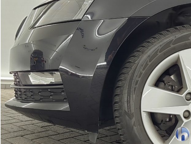
1. Voorbumper Schaafplek - Spot Repair/Deelreparatie
