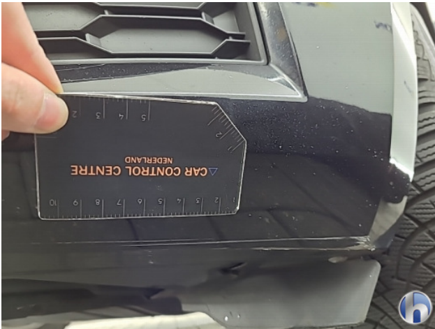
1. Voorbumper Schaafplek - Spot Repair/Deelreparatie
