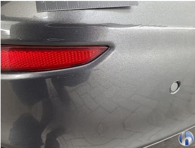
1. Achterbumper Schaafplek - Spot Repair/Deelreparatie
