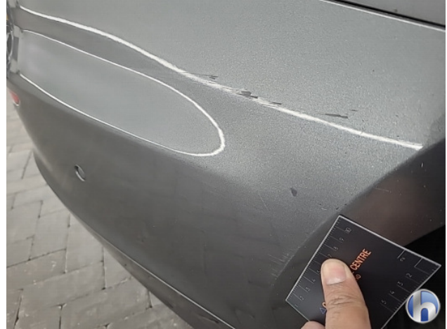
1. Achterbumper Schaafplek - Spot Repair/Deelreparatie
