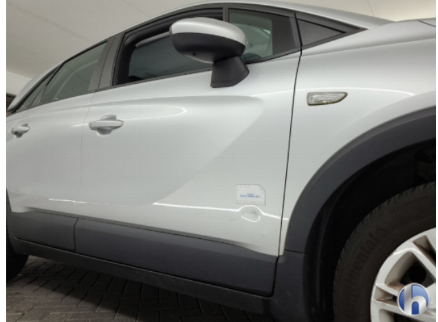
1. Portier voor - rechts Deuk/deuken - Herstellen
