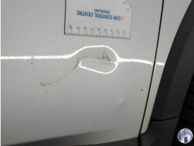
1. Portier voor - rechts Deuk/deuken - Herstellen
