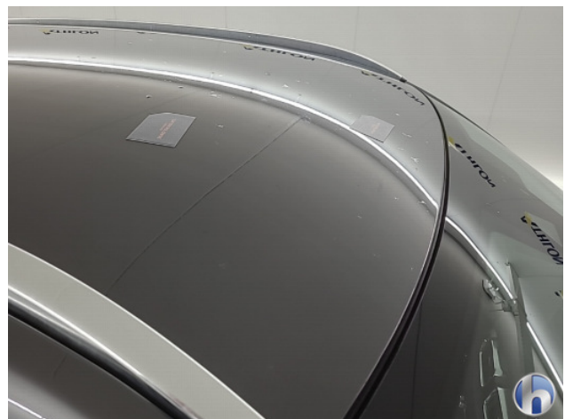
4. lakaantasting Beschadigd - Spuiten
