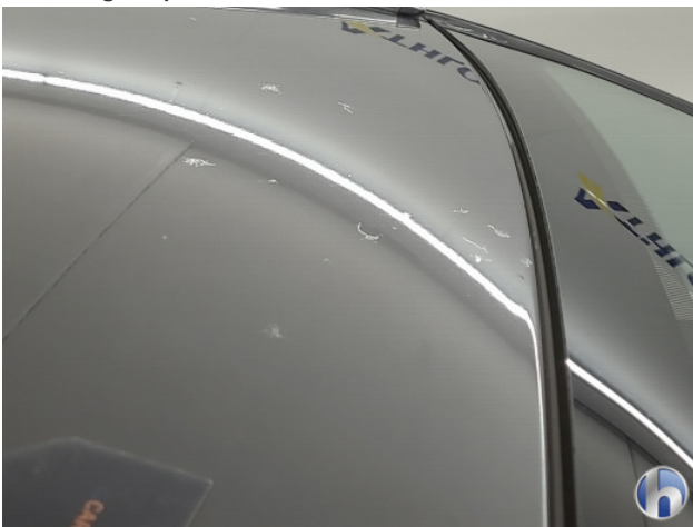
4. lakaantasting Beschadigd - Spuiten
