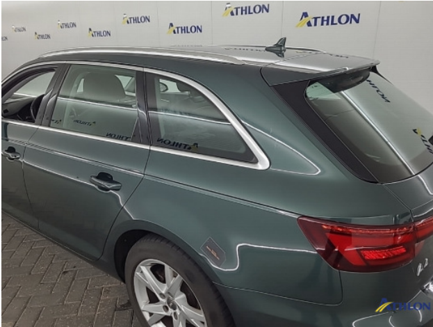
2. Zijwand - achter - Links Deuk/deuken
