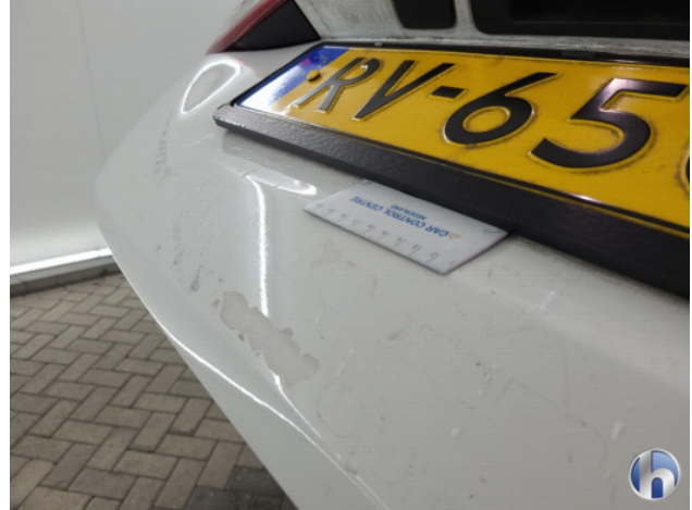
1. ontstickerschade Beschadigd - Spuiten
