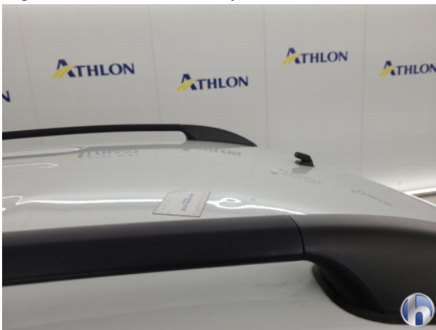
1. Dak Hagelschade - Herstellen zonder spuiten
