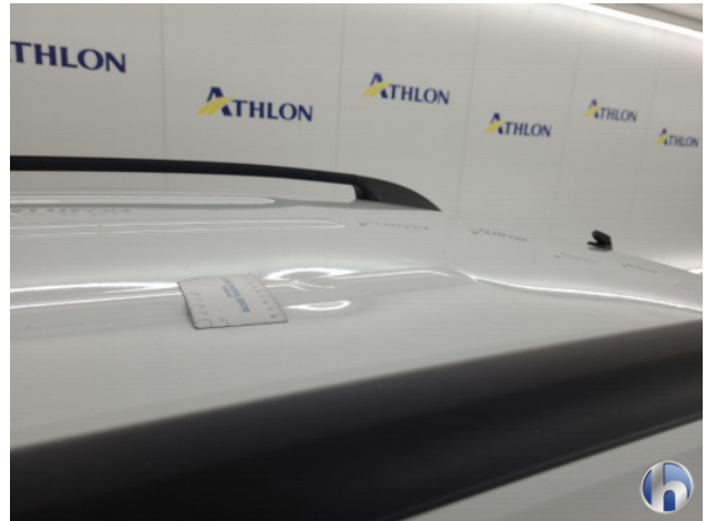
1. Dak Hagelschade - Herstellen zonder spuiten
