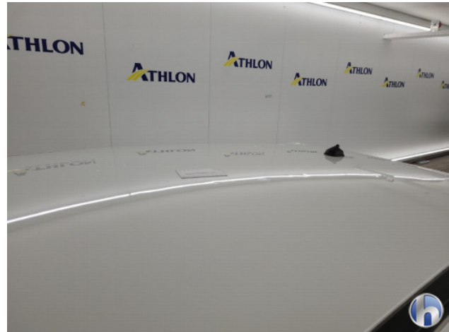
1. Dak Hagelschade - Herstellen zonder spuiten
