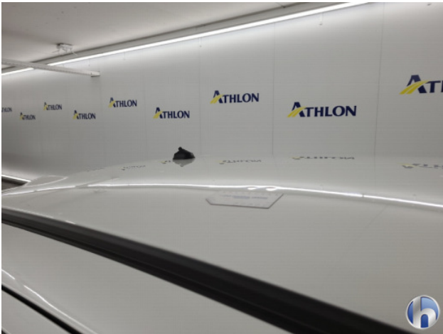
1. Dak Hagelschade - Herstellen zonder spuiten
