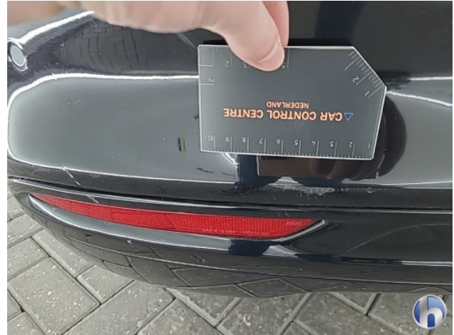
1. Achterbumper Schaafplek - Spot Repair/Deelreparatie
