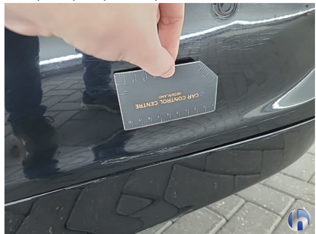
1. Achterbumper Schaafplek - Spot Repair/Deelreparatie
