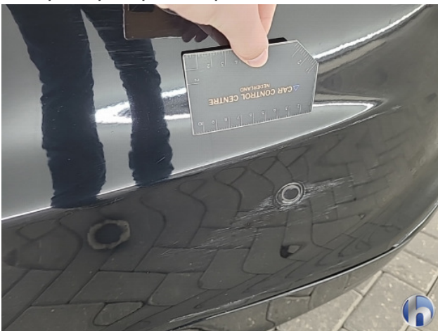
1. Achterbumper Schaafplek - Spot Repair/Deelreparatie
