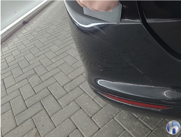
1. Achterbumper Schaafplek - Spot Repair/Deelreparatie
