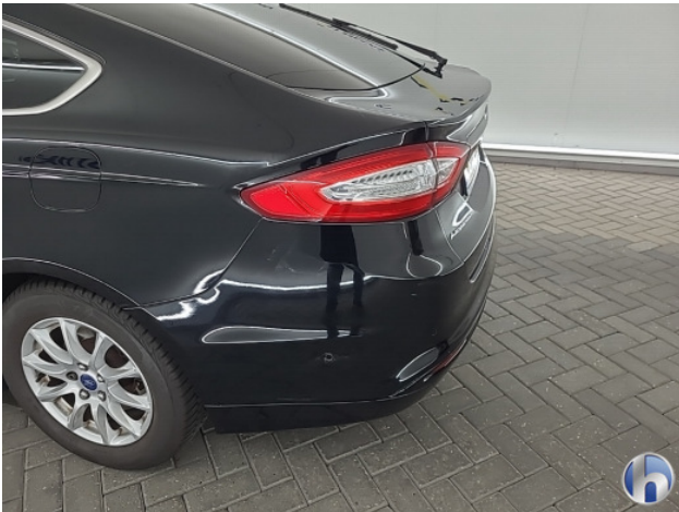
1. Achterbumper Schaafplek - Spot Repair/Deelreparatie
