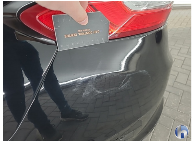
1. Achterbumper Schaafplek - Spot Repair/Deelreparatie
