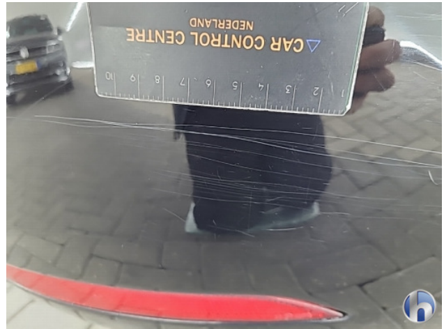
3. Achterbumper Schaafplek - Spot Repair/Deelreparatie
