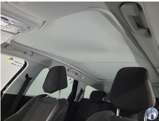
1. Panoramadak doek sluit niet goed af Gebruikssporen - Aanvaardbaar
