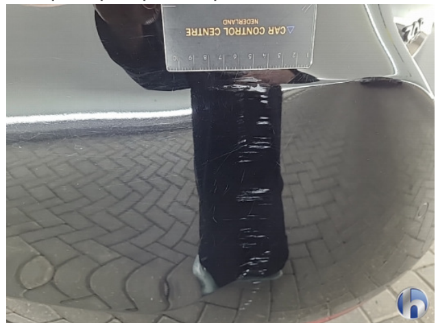
2. Achterbumper Schaafplek - Spot Repair/Deelreparatie
