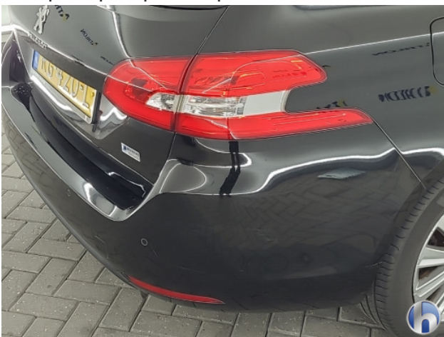
3. Achterbumper Schaafplek - Spot Repair/Deelreparatie
