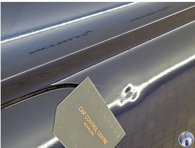
1. Zijwand - achter - Links Deuk/deuken - Herstellen
