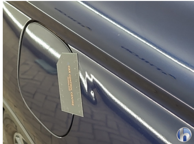
1. Zijwand - achter - Links Deuk/deuken - Herstellen
