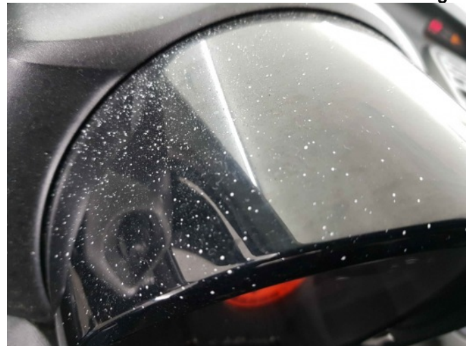
5. Diverse interieur schade verf
