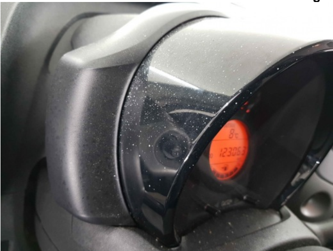
5. Diverse interieur schade verf
