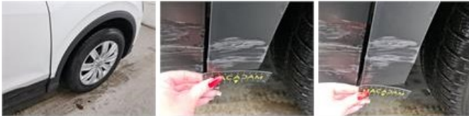
Deur V R, Vervormd / Geforceerd, Herstellen en spuiten (compleet)
