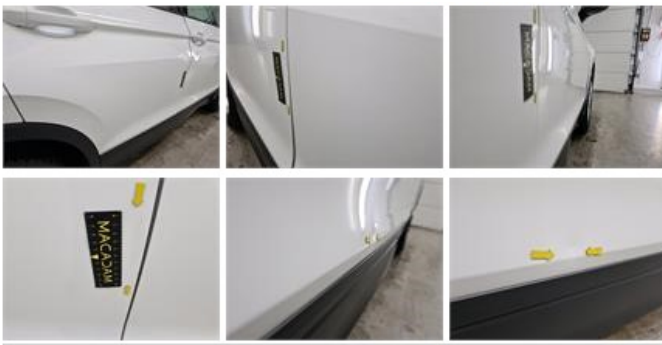
Deur V R sierlijst, Gebroken, Vervangen
