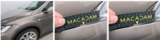
Scherf V L, Roest / Corrosie, Herstellen en spuiten (compleet)
