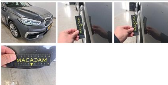
Dorpel R bekleding buiten, Gebroken, Vervangen en spuiten
