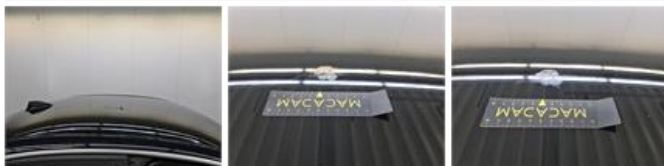
Dak, Chemische schade, Herstellen en spuiten (compleet)
