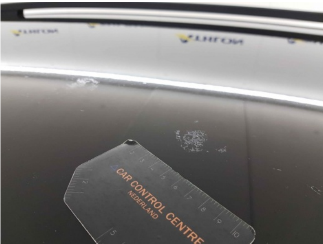
11. Ingevreten vogelpoep dak
