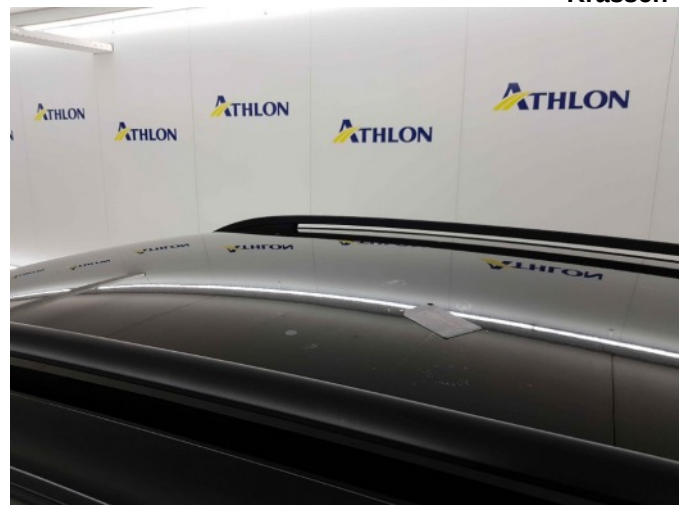
11. Ingevreten vogelpoep dak
