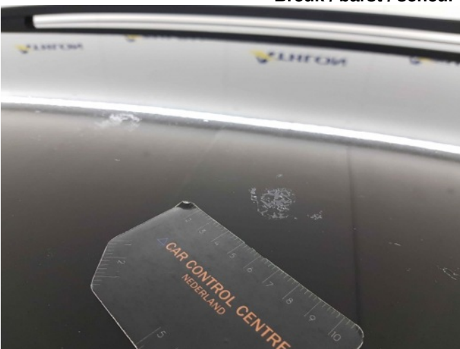
11. Ingevreten vogelpoep dak
