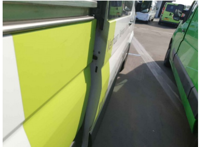
3. RA portier sluit niet correct
