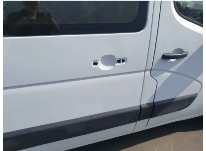
5. RA portier wilt niet open gaan/hendel Breuk / barst / scheur
