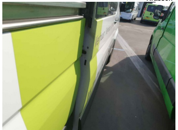
3. RA portier sluit niet correct
