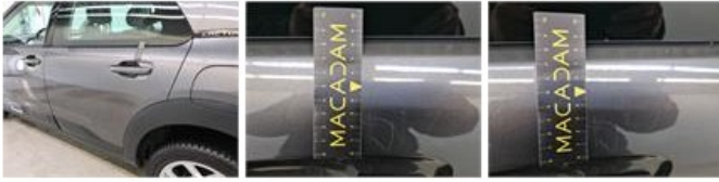
Deur A L, Kras(sen), Herstellen en spuiten (compleet)
