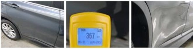
Deur A R, Slecht hersteld, Herstellen en spuiten (compleet)
