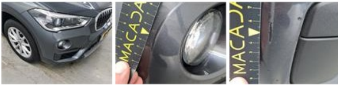
Dakstijl R, Hagelschade, Uitdeuken zonder spuiten (hagelschade)
