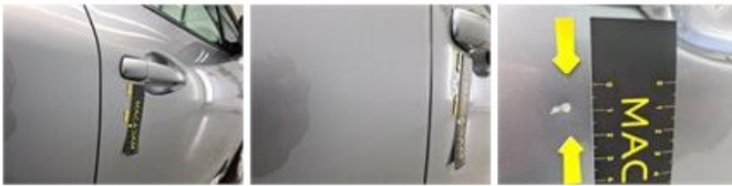
Deur V R, Deuk(en) en kras(sen), Herstellen en spuiten (compleet)
