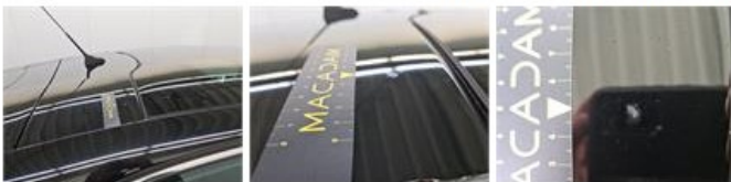
Dak, Chemische schade, Herstellen en spuiten (compleet)
