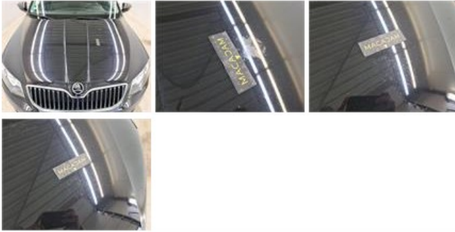
Dak, Chemische schade, Herstellen en spuiten (compleet)
