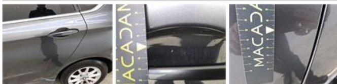
Deur A L, Kras(sen), Herstellen en spuiten (compleet)
