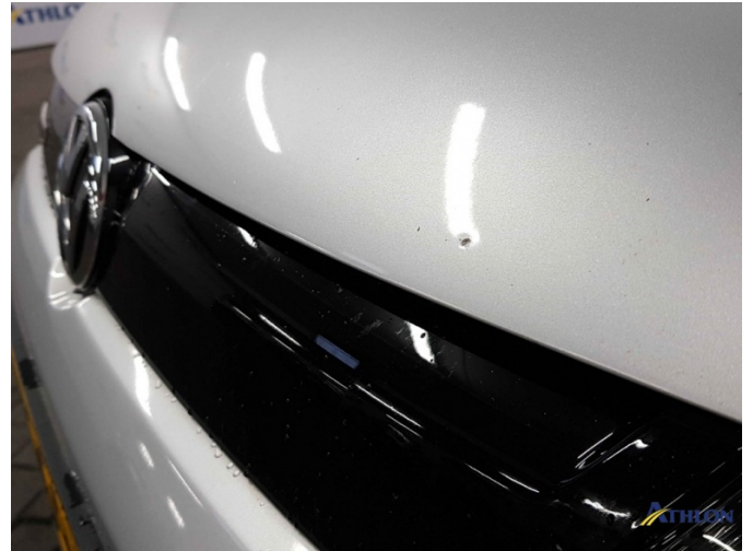
3. Motorkap Steenslag - Voorbereiden / polijsten
